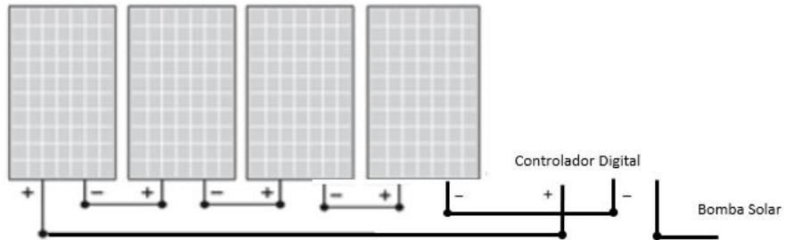
4 paneles solares de 550W
